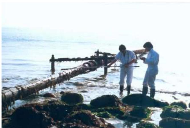
Mesures radiométriques sur la conduite de la Hague
